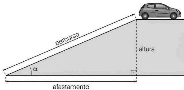
Sabendo que  $\alpha = 60^\circ$  e a altura da rampa igual a 2,5 metros, então o comprimento da rampa é:
